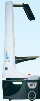
Locus ถูกออกแบบ มาให้มีลักษณะ เหมือน “เครื่อง Projector” ที่มีล้อ เคลื่อนที่ได้ และยังสามารถยกถึง / กระบะบรรจุสินค้า (Bin on Tray / Tote) ได้อีกด้วย
